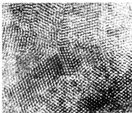
图 1 纳米硅薄膜的显微结构
